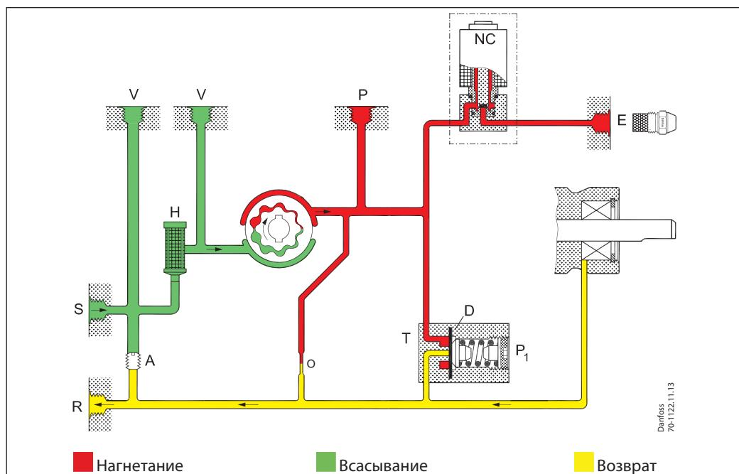
Из всасывающей линии(S), через фильтр (H) топливо поступает в шестеренчатый механизм, повышающий его давление.
